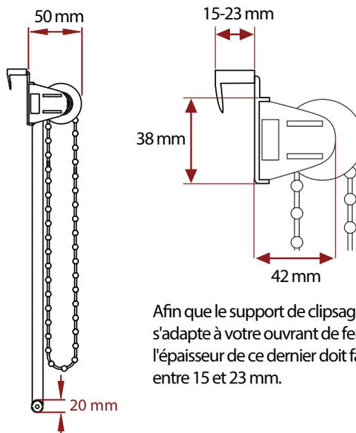
Afin que le support de clipsage s'adapte à votre ouvrant de fenêtre, l'épaisseur de ce dernier doit faire entre 15 et 23 mm.
